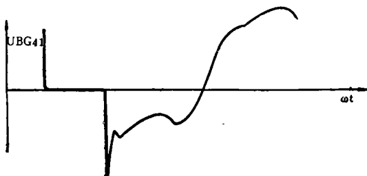
图8 负载呈容性时UBG41的波形
