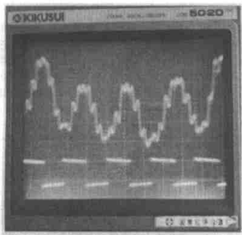
图 2 正弦激励时悬臂梁共振波形
