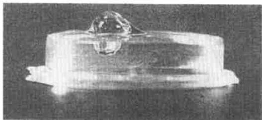
图 2 有机玻璃试样由表及里的熔化状态
