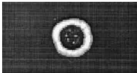
图 4 微孔聚苯乙烯底面回波 G-scan 图
