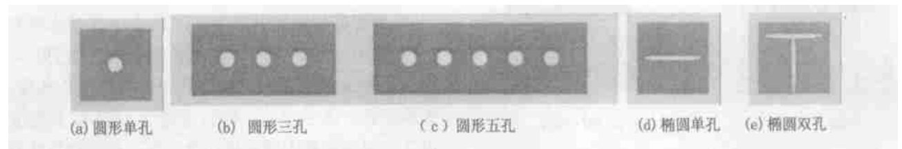
图 3 模拟生成不同缺陷的铝板
