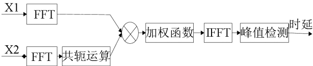
图 5 用 GCC 方法进行时延估计框图 Fig.5 Time delay estimation by using GCC method
