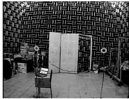
图 13 声源定位系统声源定位半消声室实验图像
