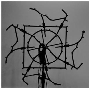
图 8 声源定位系统(64 阵元平面螺旋传声器阵列)
