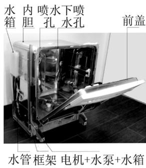
图1 洗碗机内部结构
