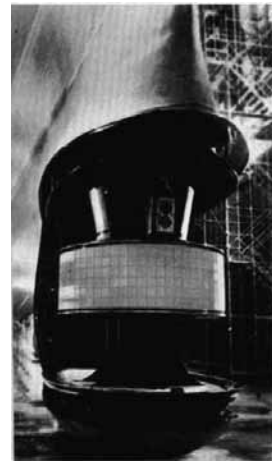
图 3 水面舰艇舰壳声纳阵: 球鼻艏声纳阵 Fig.3 Surface ship HMS: Bow Sonar Array (Photo: STN ATLAS Elektronik)
