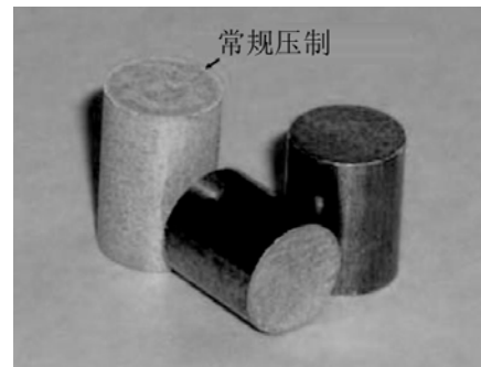
图 3 使用铜粉材料分别进行超声压制与常规压制的 5mm 直径样品 Fig.3 5mm-diameter compacts of copper powder using ultrasonic & conventional compactions
