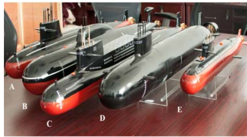
图 9 距离像测量实验的目标缩比模型 Fig.9 Target scaled model for measurement experiment
