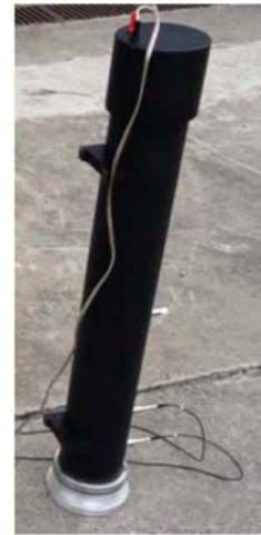
图2 加密封基座的阻抗管构造
