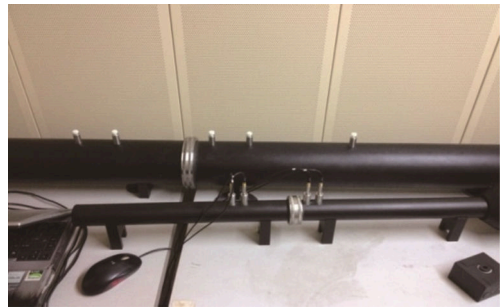
图 2 实验室测试用阻抗管 Fig.2 Impedance tube in laboratory
