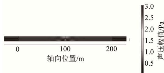
图8 由模型(a)计算的点声源频率为 16 Hz 时管廊内声场分布
