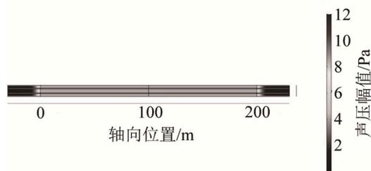
图6 由模型(a)计算的点声源频率为 1 Hz 时管廊内声场分布
