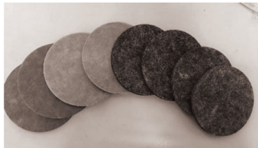
图 2 聚酯纤维吸声板成品
