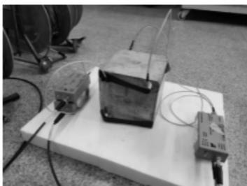
图 2 定位实验中的传感器布置方式
