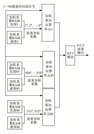
图 2 现有预存储式方法的 FPGA 实现流程 Fig.2 FPGA implementation process with the existing pre-storage method
