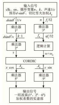
图 3 基于 CORDIC 的实时权系数生成的 FPGA 实现 Fig.3 FPGA implementation with the CORDIC based dynamic weight generation module
