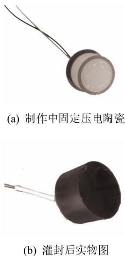
图10 聚氨酯封装前后的压电陶瓷环实物图
