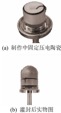
图 14 硅油耦合聚氨酯封装前后的压电陶瓷环实物图
