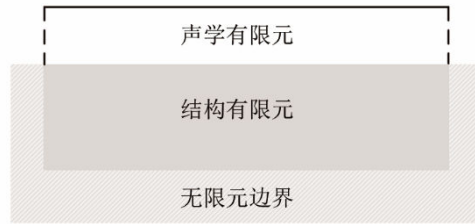
图 2 海水-海底半无限空间模型示意图 Fig.2 Schematic diagram of seawater-seabed semi-infinite space model
