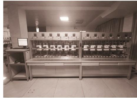
图 11 标准流量检测装置实拍
