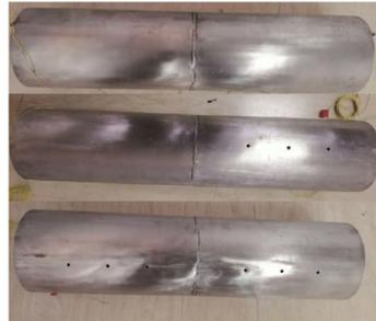
(b) 三种两舱段圆柱壳实物模型
