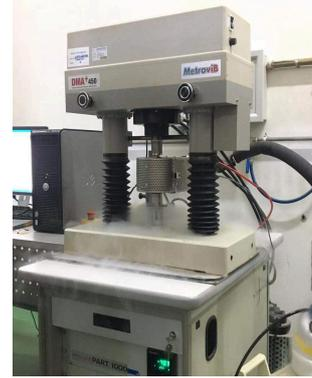
图1 基于DMA450的复杨氏模量变温试验
